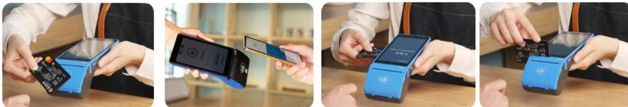
Рисунок 4.2 Расположение считывателей и способы предъявления платежной карты: бесконтактная оплата, чип, магнитная полоса.
