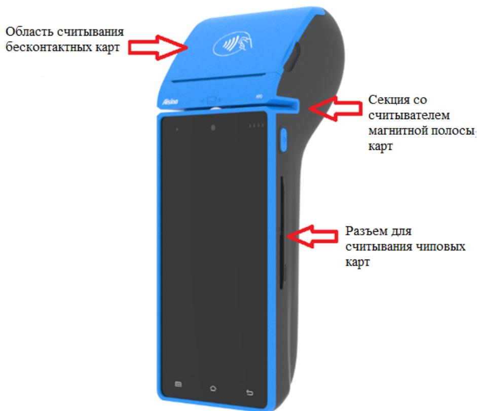
Рисунок 3.1 Общий вид и расположение считывателей карт
