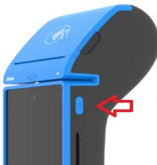
Рисунок 3.4 Кнопка включения/выключения
