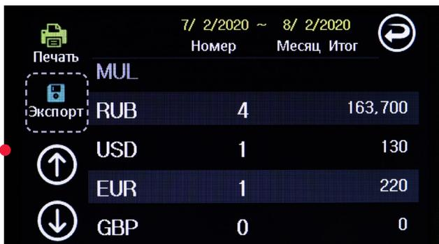
При нажатии кнопки производится выгрузка отчета на SD-карту в формате CSV.
